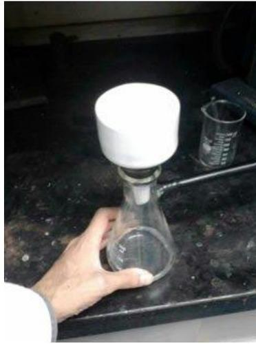
Figura 6.2 Filtración del CCZA.
