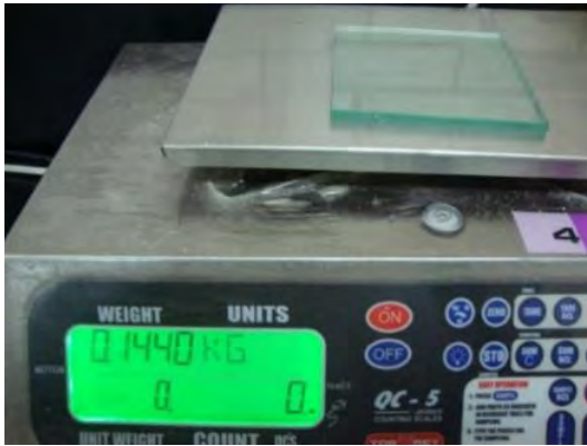
Imagen No.15 Peso de la loseta de vidrio.
