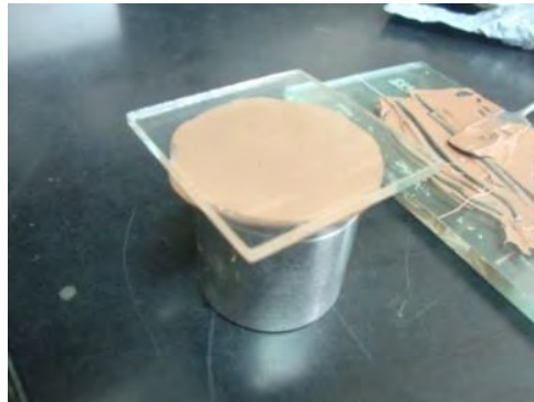
Imagen No.7 Colocación del material de impresión en el dado y colocación de la placa de vidrio.
