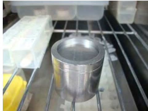
Imagen No.4 Colocación del dado en el horno.
