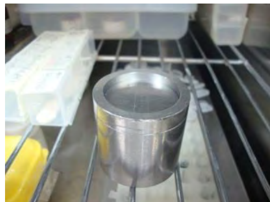
Imagen No.23 Hacedor de muestras. Imagen No.24 Colocación del hacedor en el horno.
