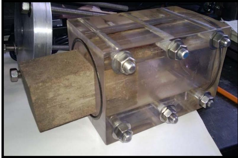
Foto 9. Montaje de la muestra de roca en la celda.
