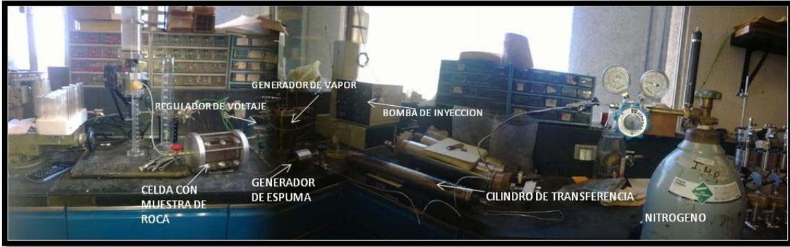
Foto 37. Diseño del tercer experimento.
