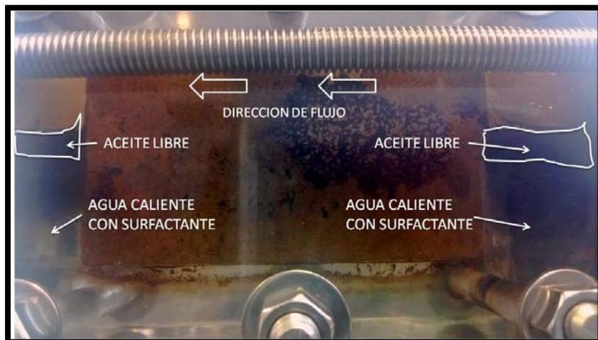
Foto 21. Inyección de agua caliente con surfactante, se observó presencia de aceite libre.
