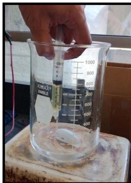
Foto 19. Mezcla del surfactante con agua destilada.
