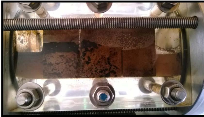
Foto 36. Condiciones al término del segundo ciclo de inyección de vapor con espuma. Se observa como la espuma se metió entre las fracturas mejorando el barrido tanto en las fracturas como en la matriz.
