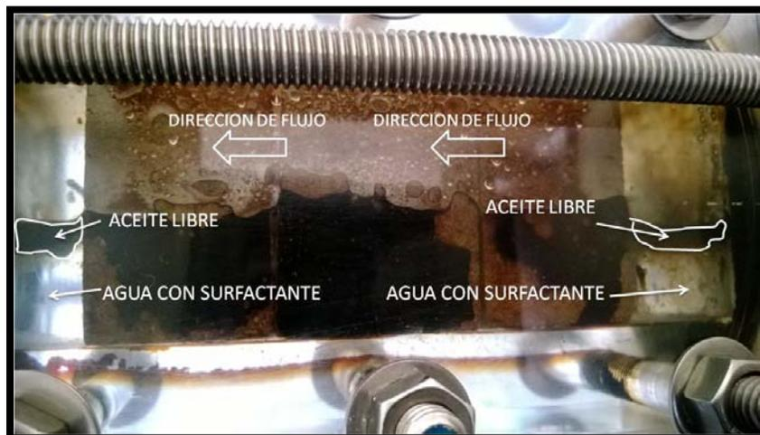
Foto 32. Inyección de agua con surfactante para calentar el sistema e iniciar con la inyección de vapor con espuma.
