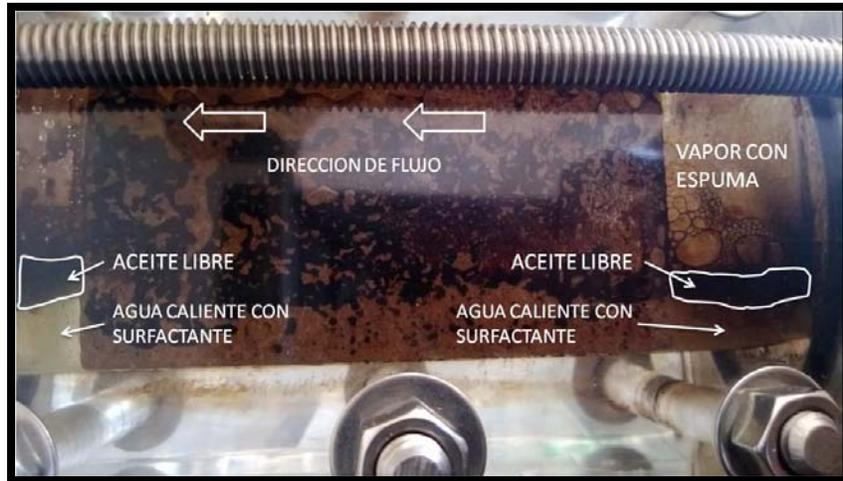
Foto 22. Primera inyección de vapor con espuma, el aceite se liberó de mejor manera ya que la espuma con vapor se metía en la matriz aunque se produjo poco.
