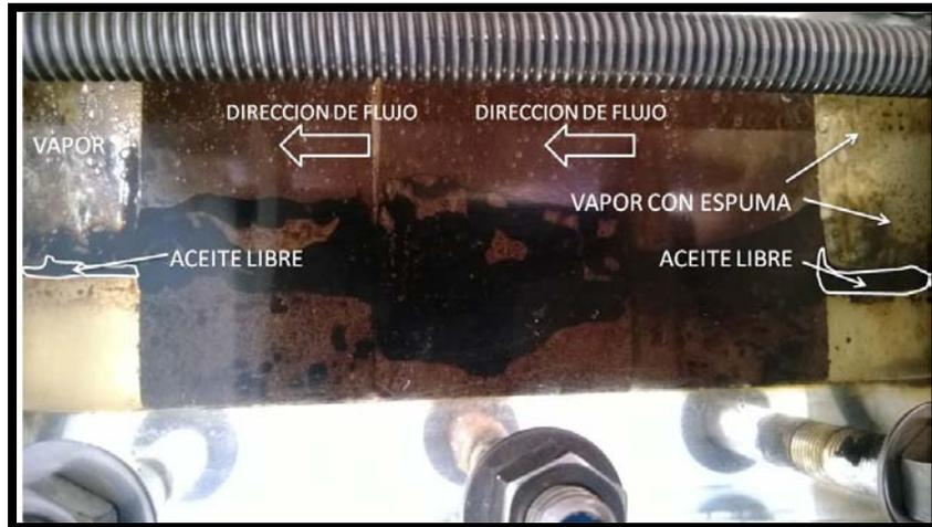
Foto 33. Primera inyección de vapor con espuma a las condiciones de cierre.
