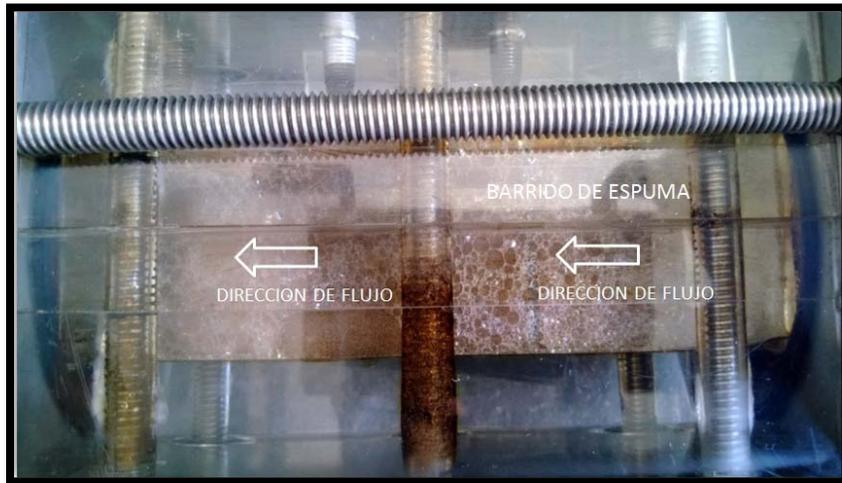
Foto 47 y 48. Se observa un mejor barrido del aceite libre con la espuma generada con nitrógeno a temperatura ambiente.
