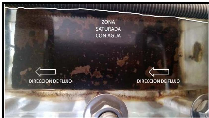
Foto 13. Se deja de inyectar agua caliente y se observa que la celda está totalmente saturada. También se ve mayor presencia de aceite libre.
