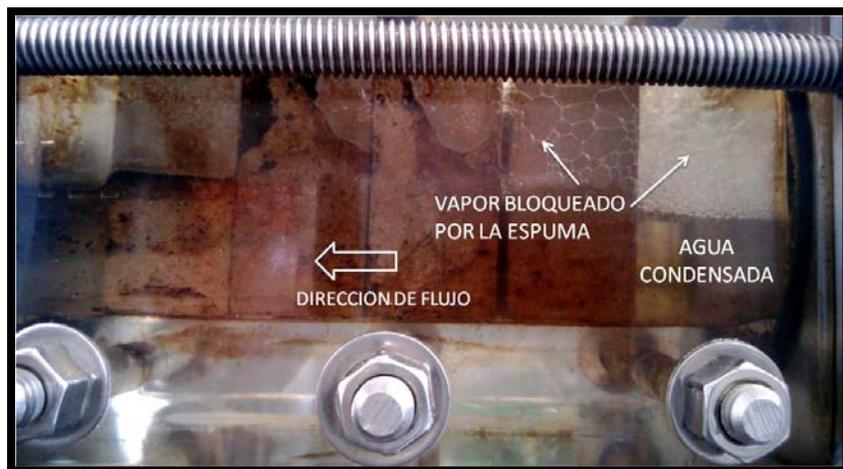
Foto 44. Se observa como la espuma bloquea el paso del vapor permitiendo que se meta a través de la matriz provocando una mayor expulsión de aceite debido a que la energía actúa directamente en la matriz, la roca y en los fluidos.
