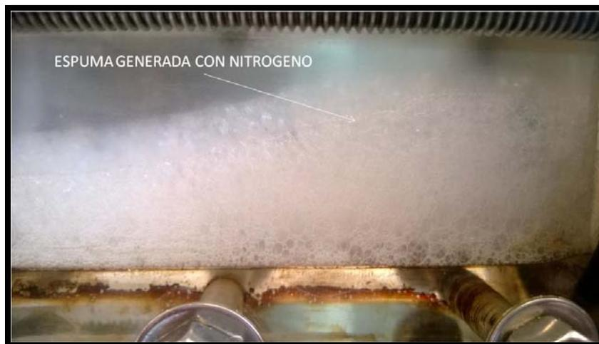
Foto 38. Pruebas de calidad de la espuma generada con nitrógeno.
