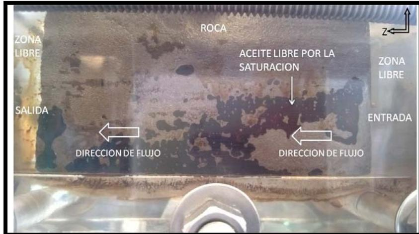
Foto 11. En la imagen se observa la muestra de roca homogénea en la celda antes de empezar a inyectar agua caliente.
