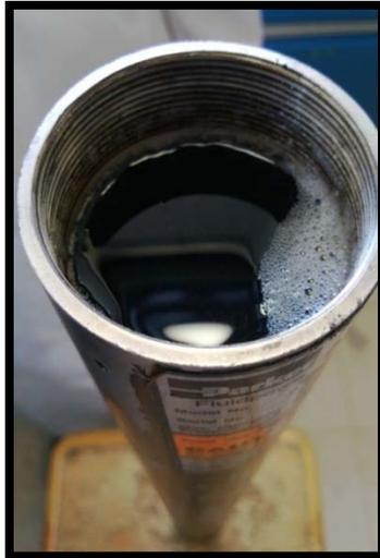
Foto 20. Surfactante en el cilindro de transferencia.
