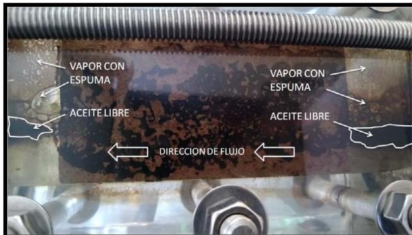
Foto 23. Segunda inyección de vapor con espuma, se observa en la entrada y en la salida de la celda presencia de espuma y vapor.
