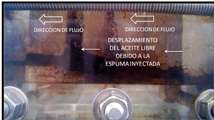
Foto 46. Al haber inyectado solo vapor en el ciclo anterior, la espuma del primer ciclo bloqueo de tal manera que actuaron en conjunto tanto el vapor como el surfactante en el sistema roca – fluidos. Esto se vio reflejado en el Fr de la última inyección de espuma con nitrógeno.
