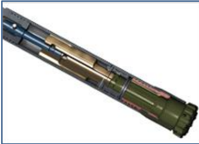
Figura 43. Esquema de martillo para perforación por percusión. Fuente: Catalogo Schlumberger.
