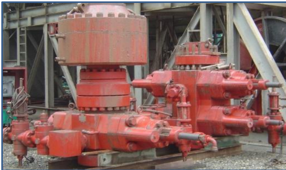
Figura 38. Arreglo de preventores usados en la perforación de pozos geotérmicos. Fuente: P. Ngugi, (2008), "Geothermal well drilling"
