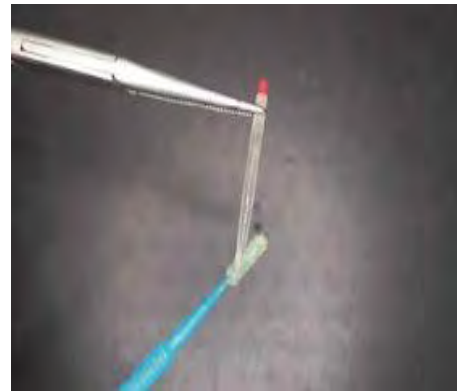
Figura 22. Limpieza del poste aplicando alcohol.
