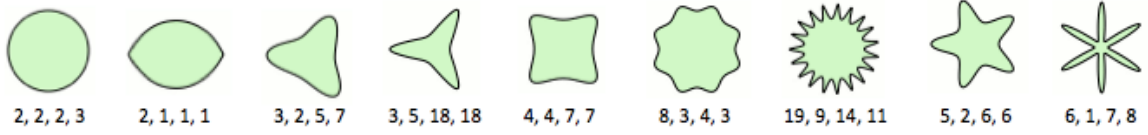
Figura 16. Ejemplo de contornos generados utilizando la superfórmula de Gielis. Bajo las figuras se muestran los valores de los parámetros m, n_1, n_2, n_3 utilizados en cada caso.
