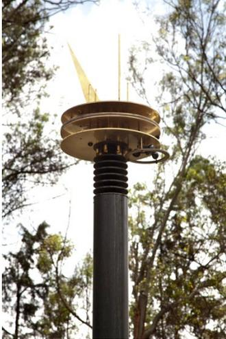
**Imagen 7: Sensor de nubes dispuesto en el exterior del edificio del Cárcamo.**
