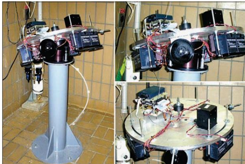
Figura 2.7. Plataforma móvil del simulador HIL de la Universidad Yonsei, Corea del Sur.
