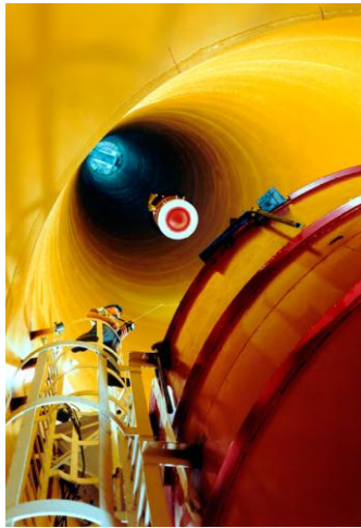
Figura 2.2. Prueba en torre de caída.
