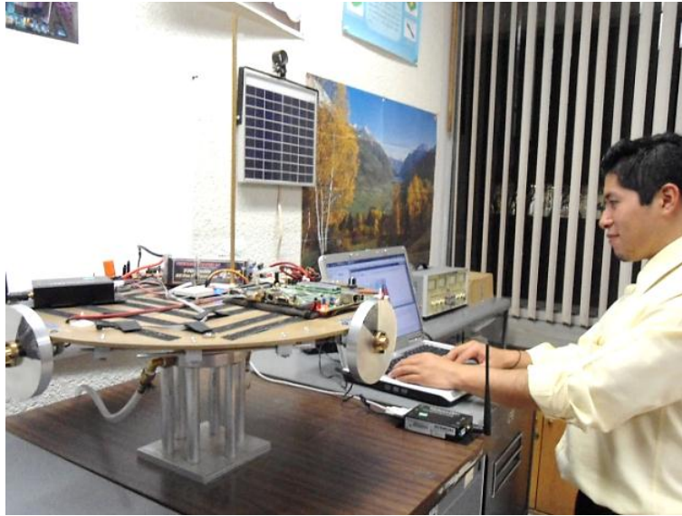
Figura 6.2. Descargando software desde una PC a la tarjeta FPGA a bordo de la MSA.
