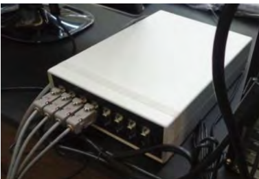
Figura 2.5 Acondicionador de señal.
