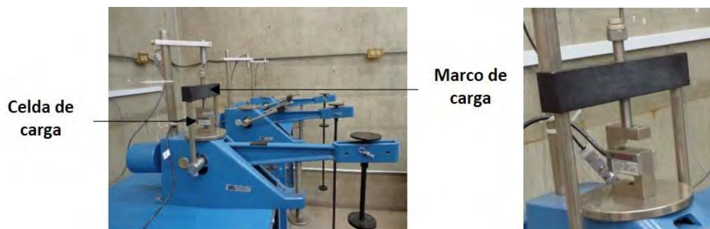
Figura 2. 24 Preparación del equipo.
