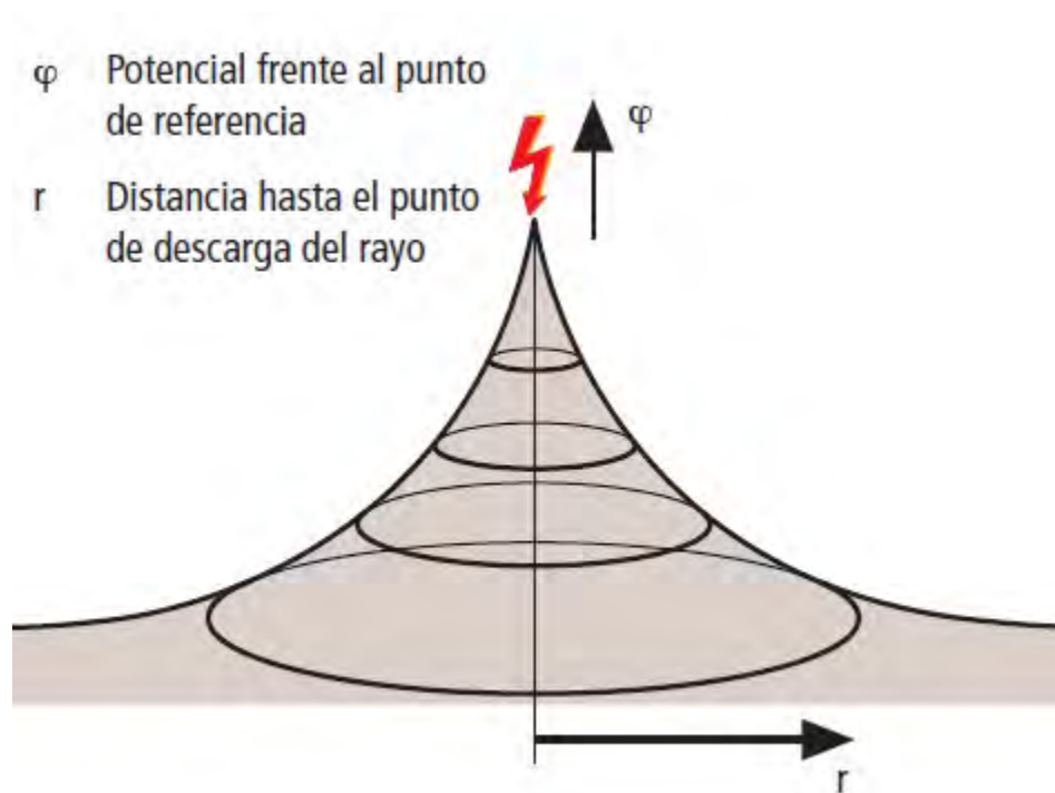
Figura 3.6; Distribución del potencial en caso de descarga de rayo en una zona de terreno homogéneo.
