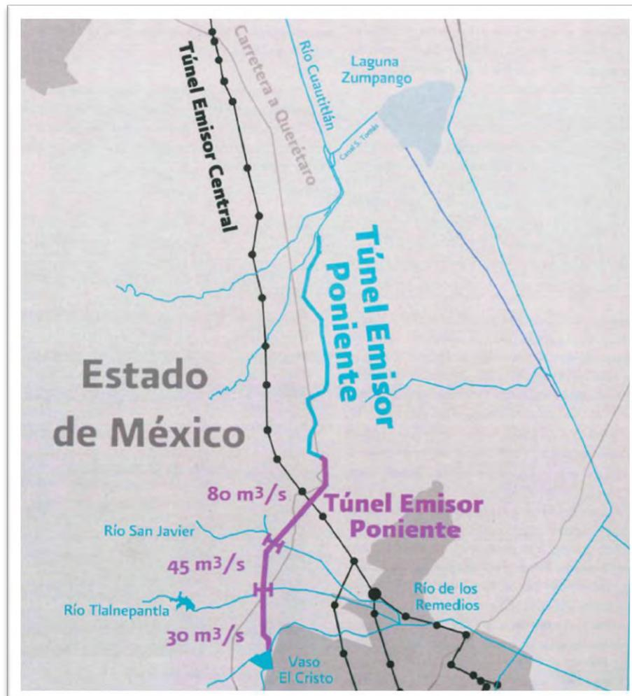
Fig. 4 Obras de drenaje asociadas al Túnel Emisor Poniente
