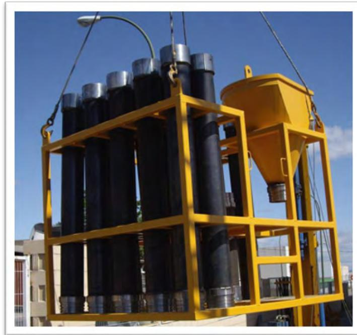
Fig. 54 Aditamentos para el sistema de colado mediante tubería Tremie
