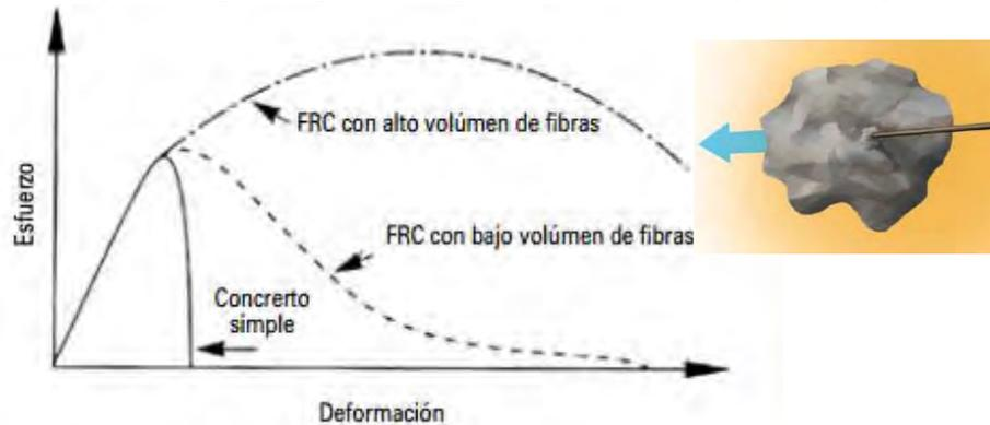
*Fig. 49 Curvas típicas de esfuerzo-deformación para concreto reforzado con fibras*
