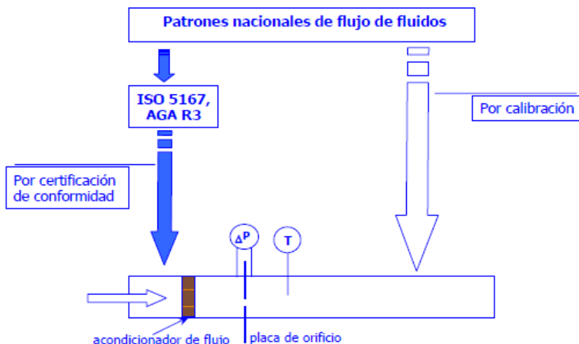
Figura I.7 Métodos de calibración y trazabilidad asociada a medidores de flujo de gas.
