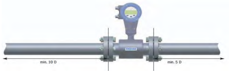
Figura II.40 Medidor ultrasónico instalado en una tubería.
