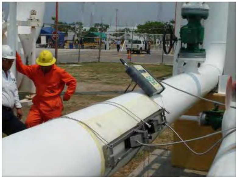
Figura II.56 Medición de la cantidad gas mandado a quema por medio un medidor ultrasónico.
