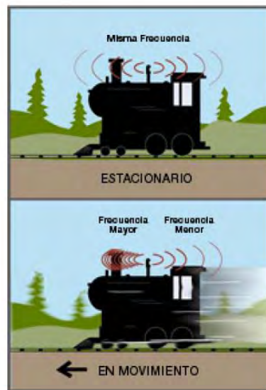
Figura II.42 Ejemplo ilustrativo del efecto Doppler.
