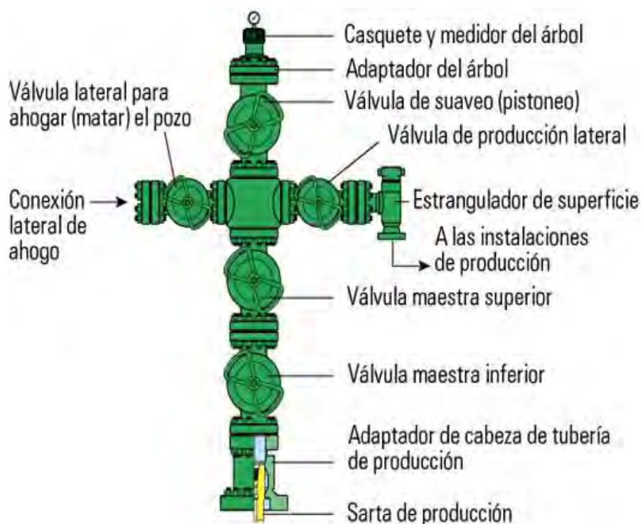
Figura II.3 Árbol de válvulas que muestra la ubicación de un estrangulador.
