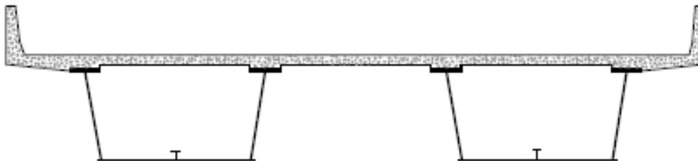
Figura 1.19 Sección transversal representativa de vigas de cajón compuesto.
