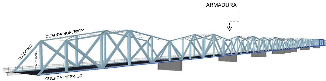
Figura 1.12 Puente de armadura.
