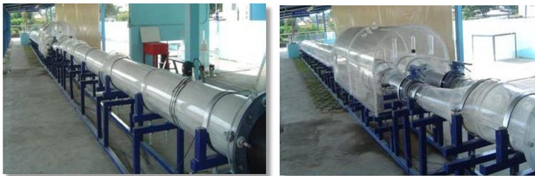
Figura No. 26 Modelo físico del desagüe de fondo La Yesca (Lab. CFE, 2010).
