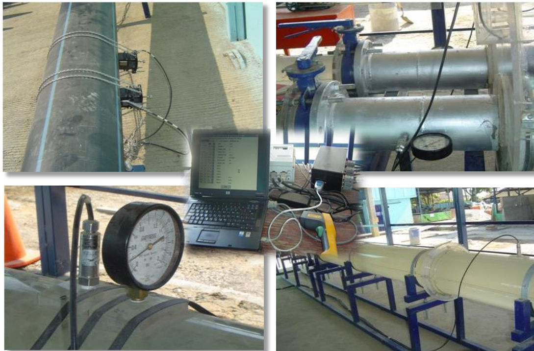
Figura No. 28 Equipo de medición y registro del modelo físico (Lab. CFE, 2010).
