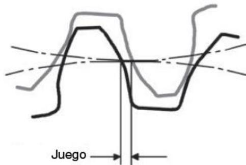
*Figura 3.2 Representación gráfica del juego mecánico entre dos engranes.*
