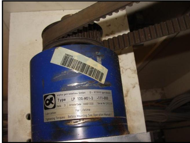
*Imagen 5.2 Identificación de modelo y relación de transmisión directamente de la placa de datos del reductor.*
