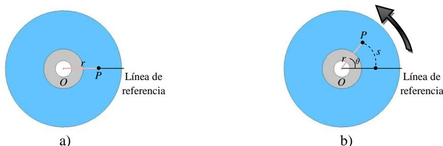
**Figura 1.12** Disco compacto que gira en torno a un eje fijo a través de  $O$  perpendicular al plano de la figura, a) Para definir la posición angular del disco, se elige una línea de referencia fija. Una partícula en  $P$  se ubica a una distancia  $r$  desde el eje de rotación en  $O$ . b) Conforme el disco da vueltas, una partícula en  $P$  se mueve a través de una longitud de arco  $s$  sobre una trayectoria circular de radio  $r$ .
