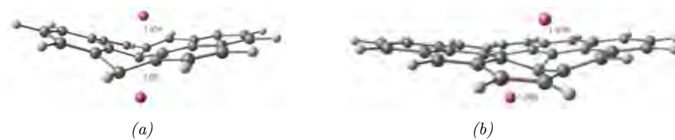
Figura 5.2: Estructura optimizada de adsorción de dos átomos Litios sobre (a) una hojuela de seis anillos y (b) hojuela de 9 anillos de benceno.
