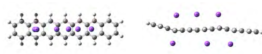
Figura 5.19: Se muestra la configuración de mínima energía para de la adsorción de tres pares de Sodios en el el segundo, cuarto y sexto anillo del heptaceno, obtenida del cálculo realizado con el método de DFT, con el potencial B3LYP y el conjunto de bases 6-311g(d).
