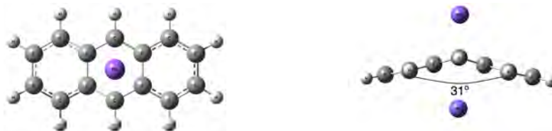
Figura 5.16: Se muestra la configuración de mínima energía para de la adsorción de un par de Sodio en el anillo central del antraceno, obtenida del cálculo realizado con el método de DFT, con el potencial B3LYP y el conjunto de bases 6-311g(d).
