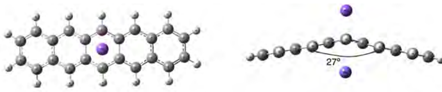
Figura 5.17: Se muestra la configuración de mínima energía para de la adsorción de un par de Sodio en el anillo central del pentaceno, obtenida del cálculo realizado con el método de DFT, con el potencial B3LYP y el conjunto de bases 6-311g(d).
