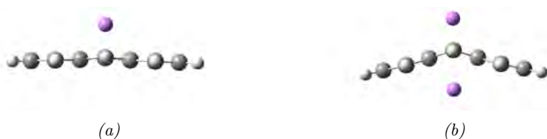
Figura 5.5: adsorción de (a) uno Litio y (b) dos Litios sobre el anillo central del antraceno. La estructura ha sido optimizada usando el método de DFT con el funcional B3LYP y el conjunto de bases 3-21g*.
