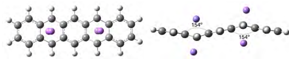
Figura 5.13: Se muestra la configuración de mínima energía para el pentaceno con adsorción de cuatro Litios en el segundo y cuarto anillo.
