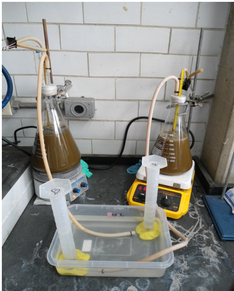
Figura 6; digestores con sus respectivos medidores de biogás
