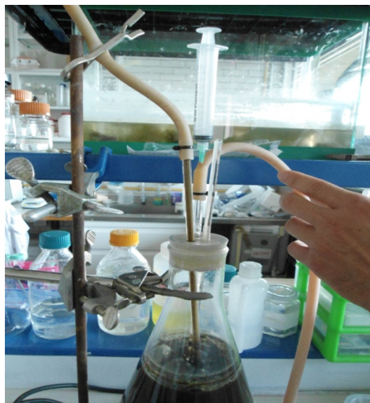
Figura 7; extracción de biogás en los sistemas
