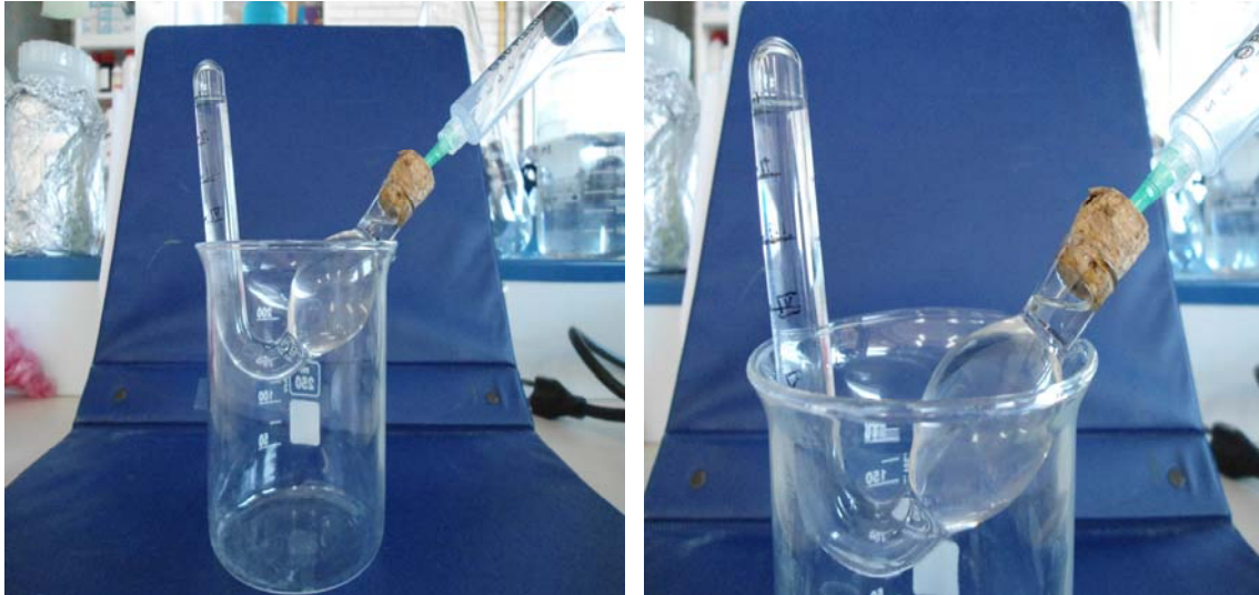
Figura 8; Sistema con el que se determinó la composición de CH 4 en el biogás
