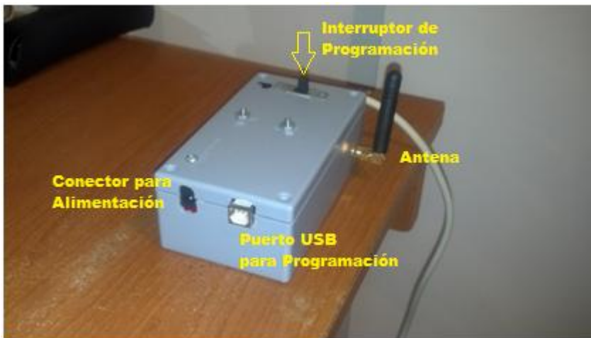
(Figura 3.14 – Caja protectora del sistema, interruptor para programación y antena)
