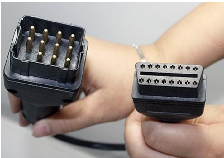
(Figura 2.11 – Del lado izquierdo se ve un conector OBD-I Renault; del lado derecho un conector DLC de OBD-II) [2,14]
