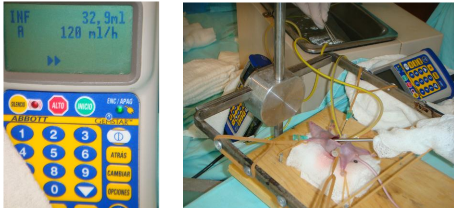
FIG. a) bomba de infusión marcando el flujo continuo entrante en la cavidad abdominal. b) Sistema de flujo entrante y saliente en conjunto con la bomba de infusión y la maquina de termoregulacion de soluciones.
