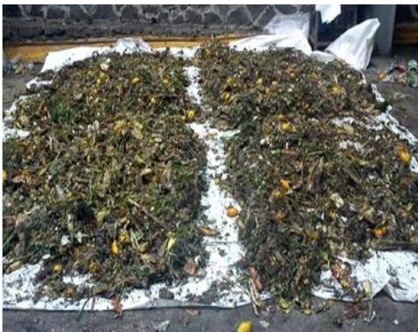
Figura 4.1 Montículo de la FORSU – Amecameca siendo divididos en cuatro partes conforme al método del cuarteo.
