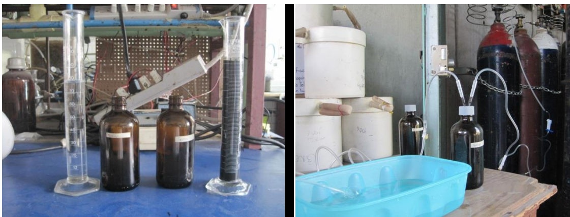
a) b) Figura 3.4 (a) Frascos con mezcla de sustrato e inóculo para la determinación del PBM, (b) frascos conectados al tanque de N_2 para su burbujeo
