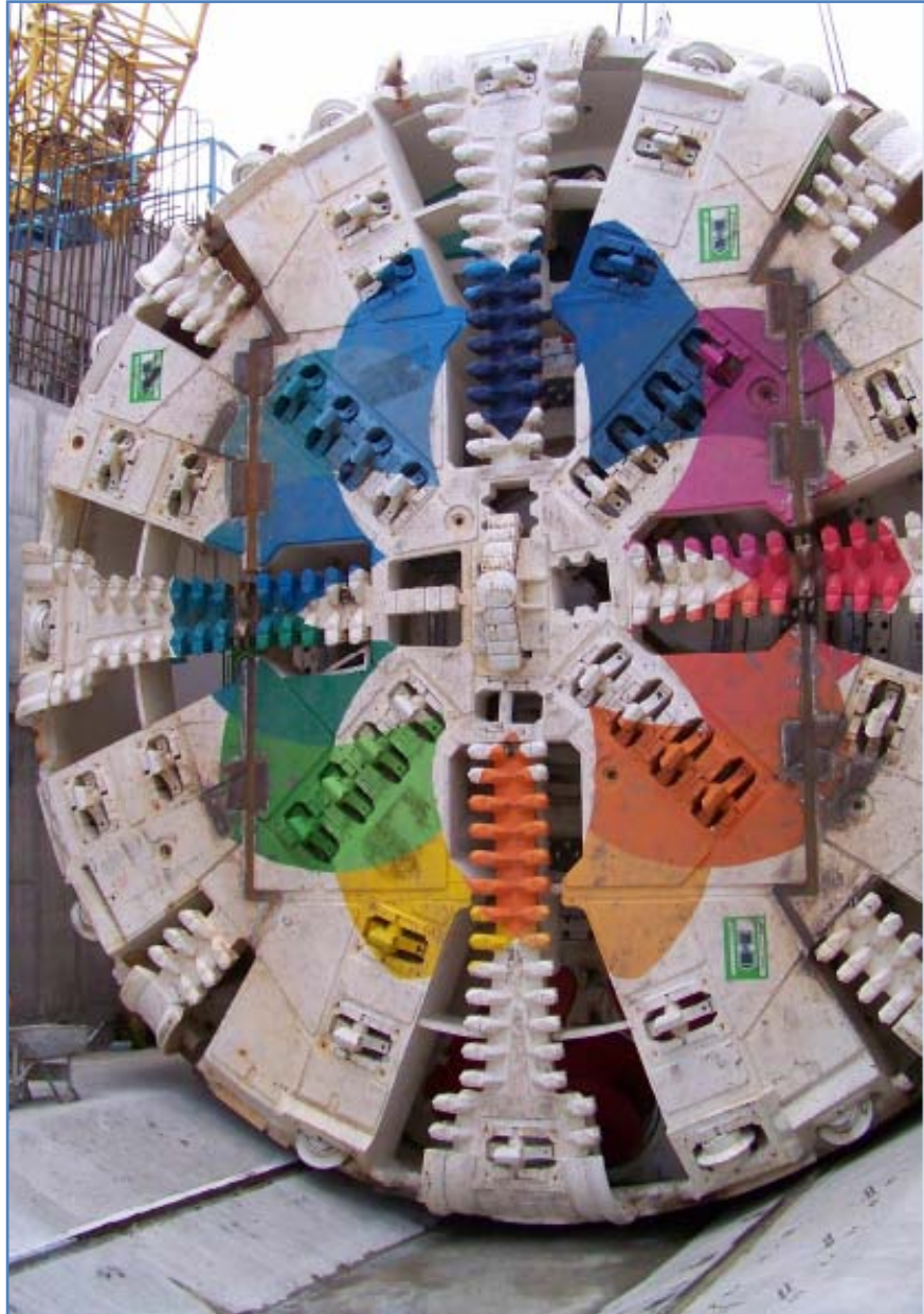
Frente de excavación de tuneledora.
