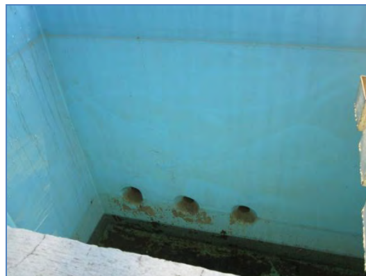
Fotografía 3.2. Entrada a la tubería del dispositivo experimental
