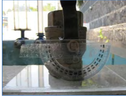
Fotografía 3.3. Dispositivo de medición de apertura de válvula
