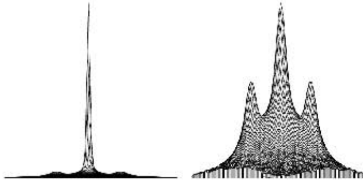
Figura 1.7: Función de autocorrelación de la estrella binaria DF Tau ( \rho = 0''.1 , \Delta m = 0.23 mag), (izquierda) sin la corrección de fotones y (derecha) con la corrección (Pluzhnik , 2005).
