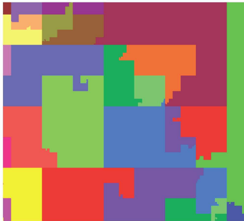
Figura 3.3: La distribución del dominio entre los distintos procesadores utilizando la función de llenado de Hilbert.
