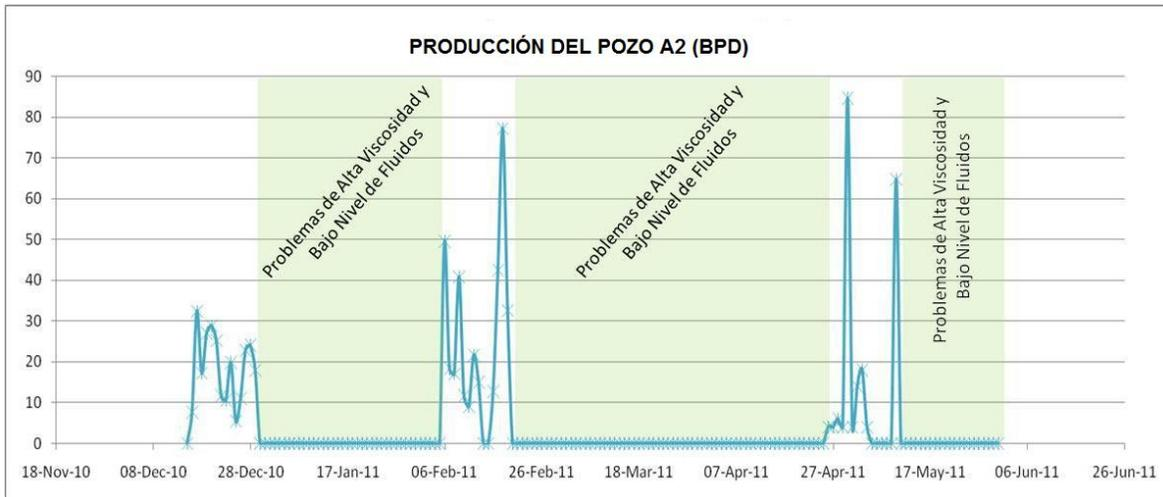
**Figura 5. 17 Producción del Pozo A2 durante la Prueba Tecnológica.**
