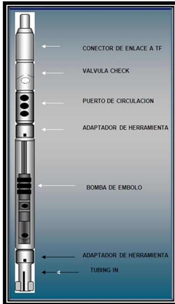
Figura3. 19 Diagrama del Ensamblaje de Fondo.
