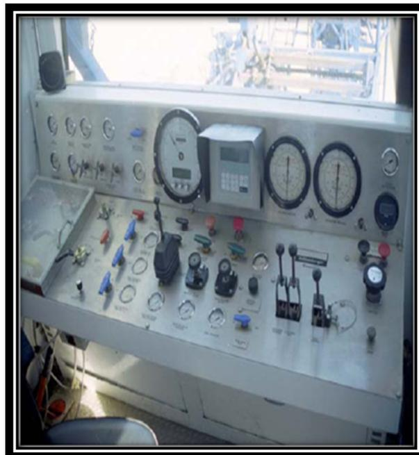
Figura3. 8 Cabina de control de una unidad de tubería flexible.
