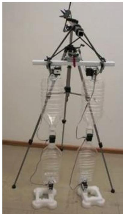
**Figura 3.8** Prototipo de piernas robóticas.
