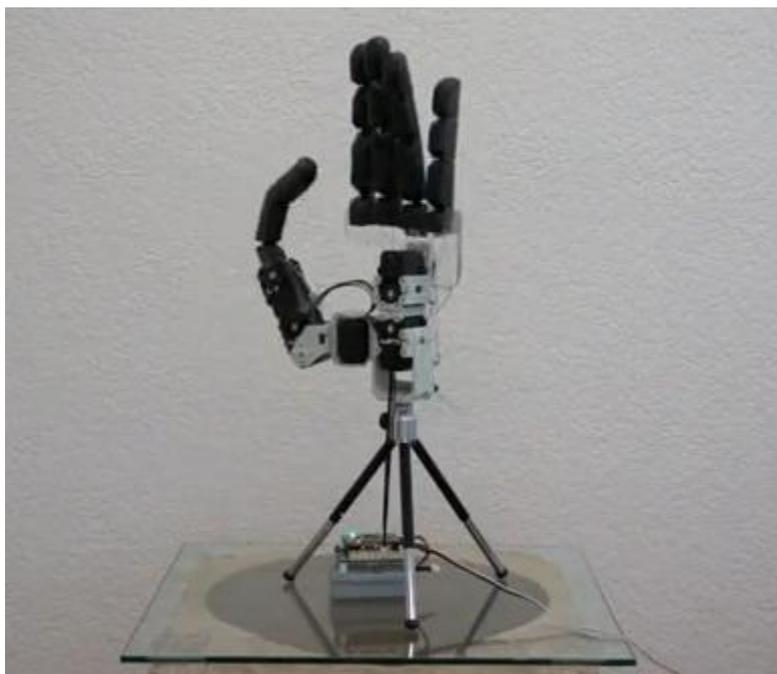
**Figura 3.2** Prototipo de prótesis robótica de mano (Versión 1).
