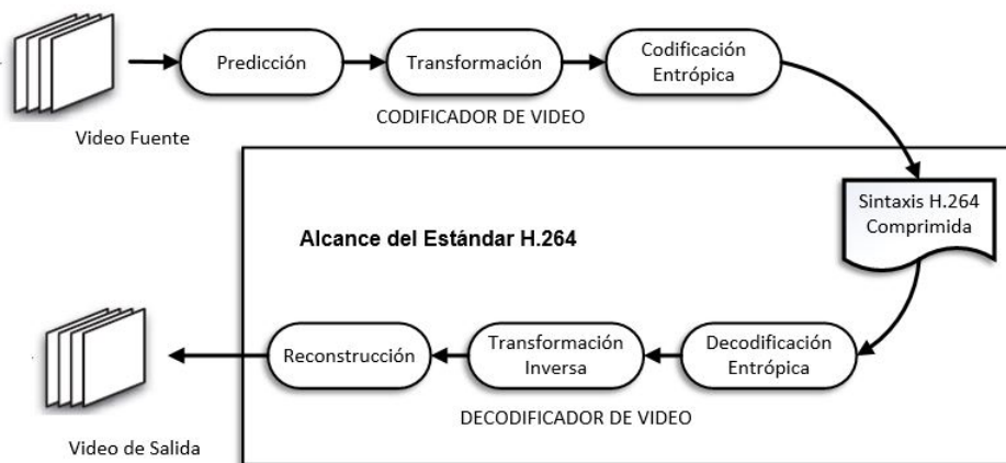
Figura 2.1: Procesos de codificación y decodificación de video H.264
