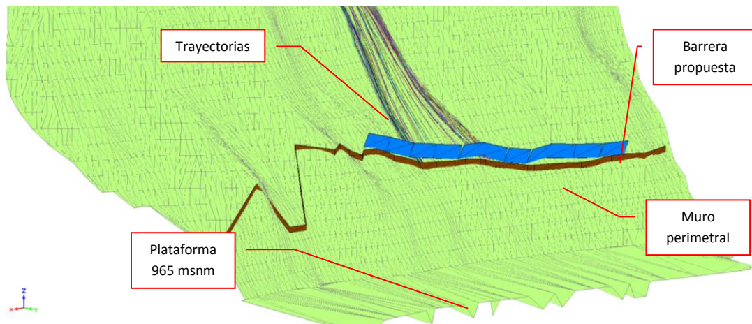
Figura 6.41 Trayectorias de los fragmentos rocosos provenientes de la zona de lanzamiento2, limitadas por la presencia de la barrera propuesta.
