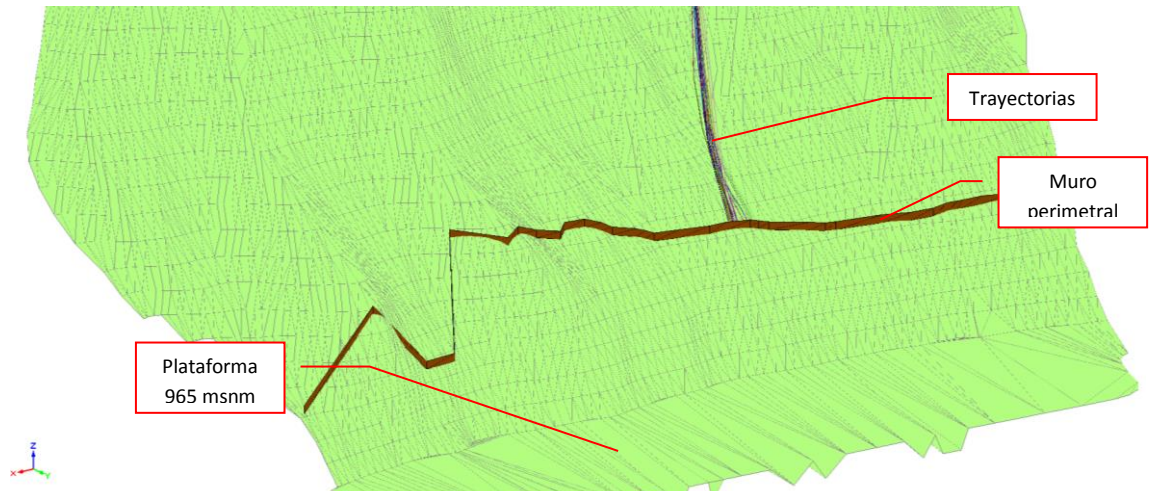
Figura 6.28 Trayectorias de los fragmentos rocosos para la zona de lanzamiento 3A.
