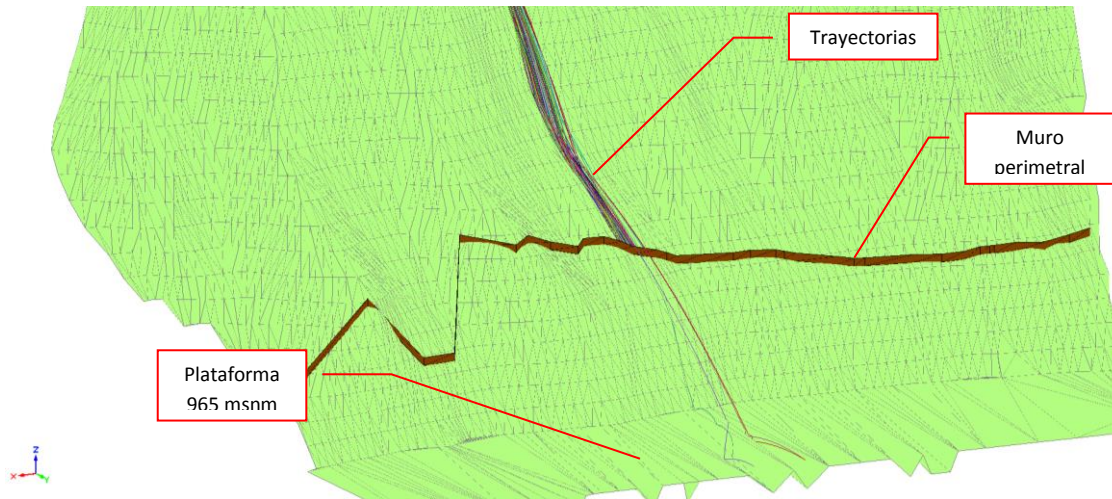
Figura 6.36 Trayectorias de los fragmentos rocosos para la zona de lanzamiento 6.
