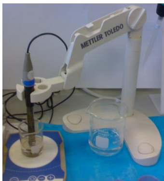
Figura 23. Humectación del electrodo, antes de su calibración.
