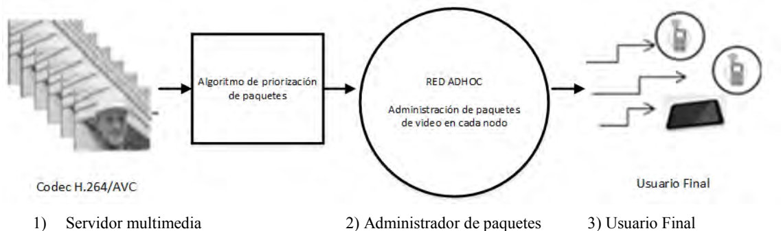
Figura 1.1 Diagrama básico que presenta la priorización y administración de paquetes de video.
