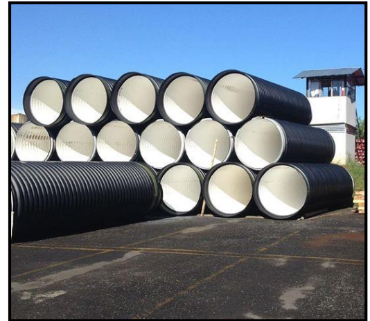
Figura 2.2.4 Alcantarilla de tubo de polietileno de alta densidad
