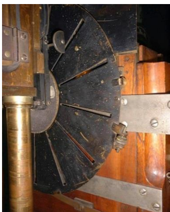
Fig. 25. Detalle del Obturador de disco ranurado del Zoopraxiscopio. E. Muybridge.
