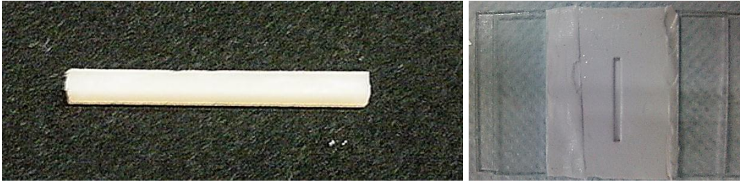
Figura 23. a) Muestra de resina compuesta que sirvió de modelo. b) Molde a base de silicona por condensación para la confección de muestras para la prueba de flexión. Fuente: Directa.
