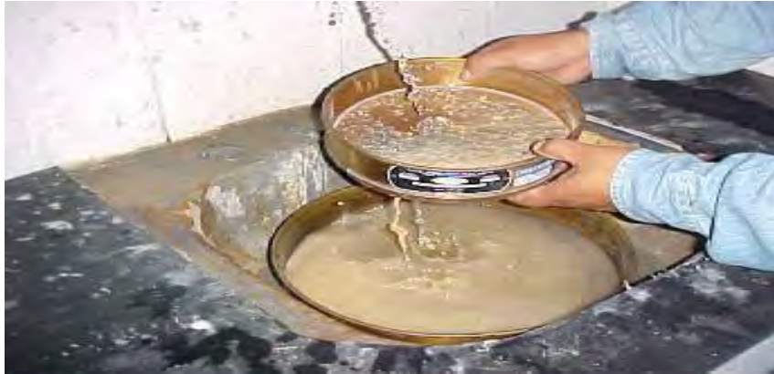
(Figura 3.8). Pérdida por lavado de agregado para concreto.
