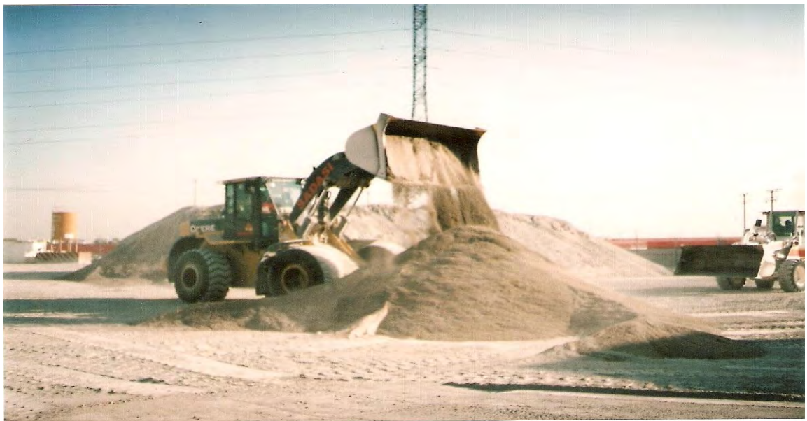
Figura 2.10 a. En esta imagen se realiza la homogeneización de la arena para tener un mejor control de la humedad.
