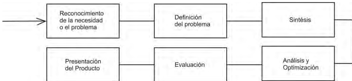
Figura 11. Esquema del proceso del diseño en ingeniería [18].
