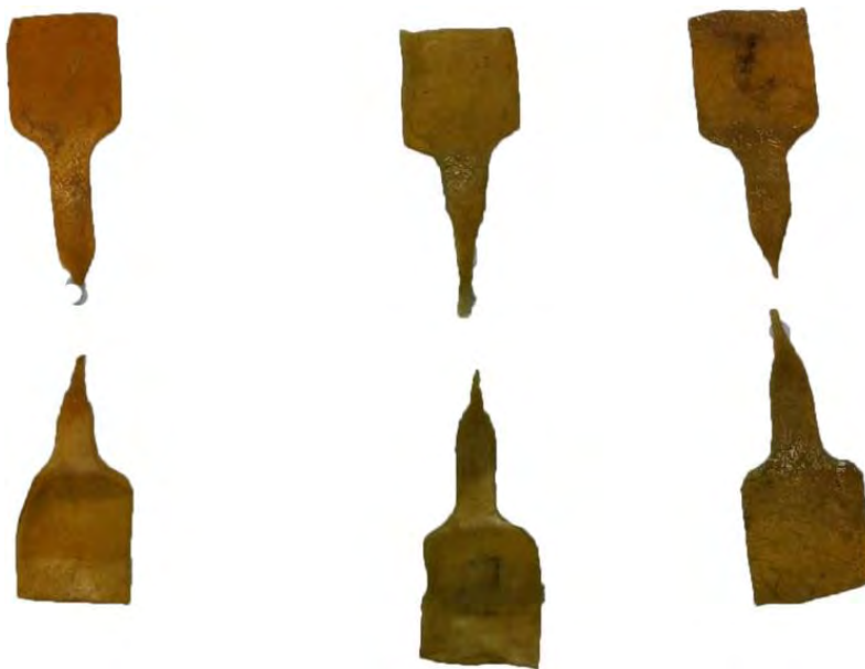
Figura 117. Probetas de pericardio bovino al finalizar el ensayo de tracción. De izquierda a derecha se encuentran probeta de pericardio bovino 1, probeta de pericardio bovino 2, probeta de pericardio bovino 3, respectivamente.
