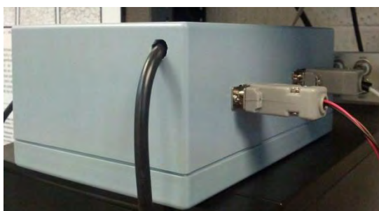
Figura 76. Fuente de alimentación de alimentación, acondicionamiento de señal y rectificación asociada al LVDT HR4000.
