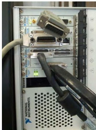
Figura 84. Chasis PXI, con las tarjetas de comunicación asociadas.
