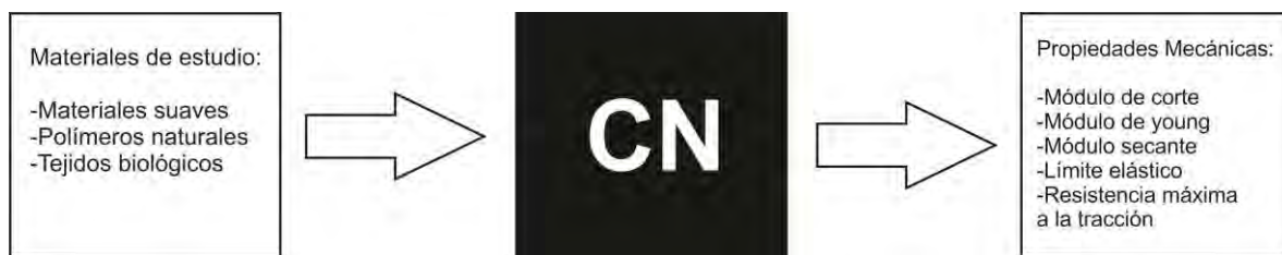
Figura 12. Modelo de caja negra del Probador mecánico.
