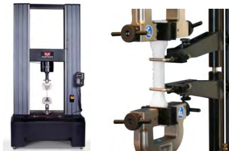
Figura 7. Equipo Instron para ensayos de tracción (izquierda). Sistema de mordazas (derecha).
