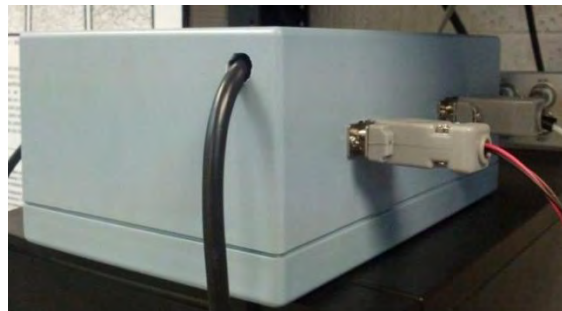
Figura 74. Fuente de alimentación de alimentación asociada a la celda de carga HoneywellBR-34 (15 [kg]).
