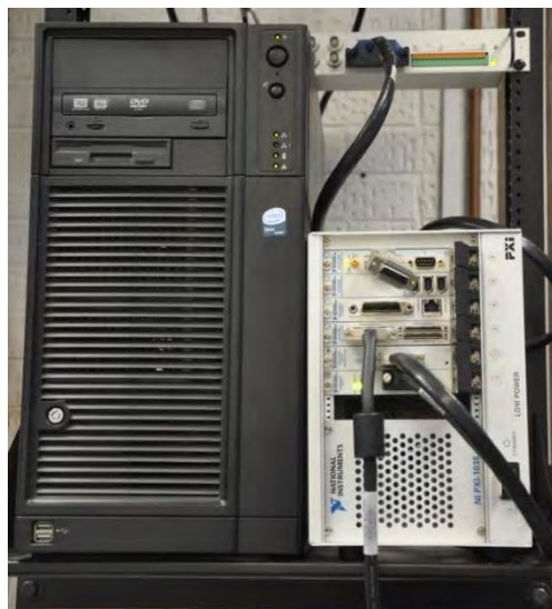
Figura 86. Bloque conector BNC, con la PXI, mas comunicación con PC.
