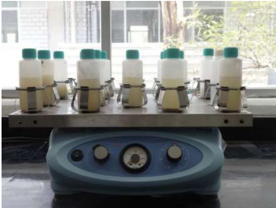
Figura 4. 8. Imagen fotográfica del dispositivo utilizado para la determinación de la concentración geodisponible de acuerdo al Apéndice Normativo “B” de la NOM-147-SEMARNAT/SSA1-2004.
