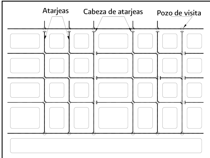
Figura 1.3 Trazo combinado en red de atarjeas (SGAPDS-29-10-16defeb2010)
