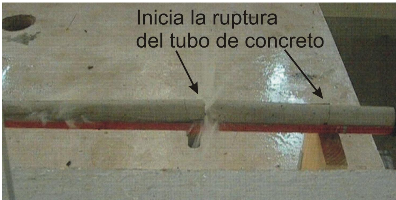
Figura 5.24 Inicio de la ruptura y de la fuga de agua en el tubo de concreto
