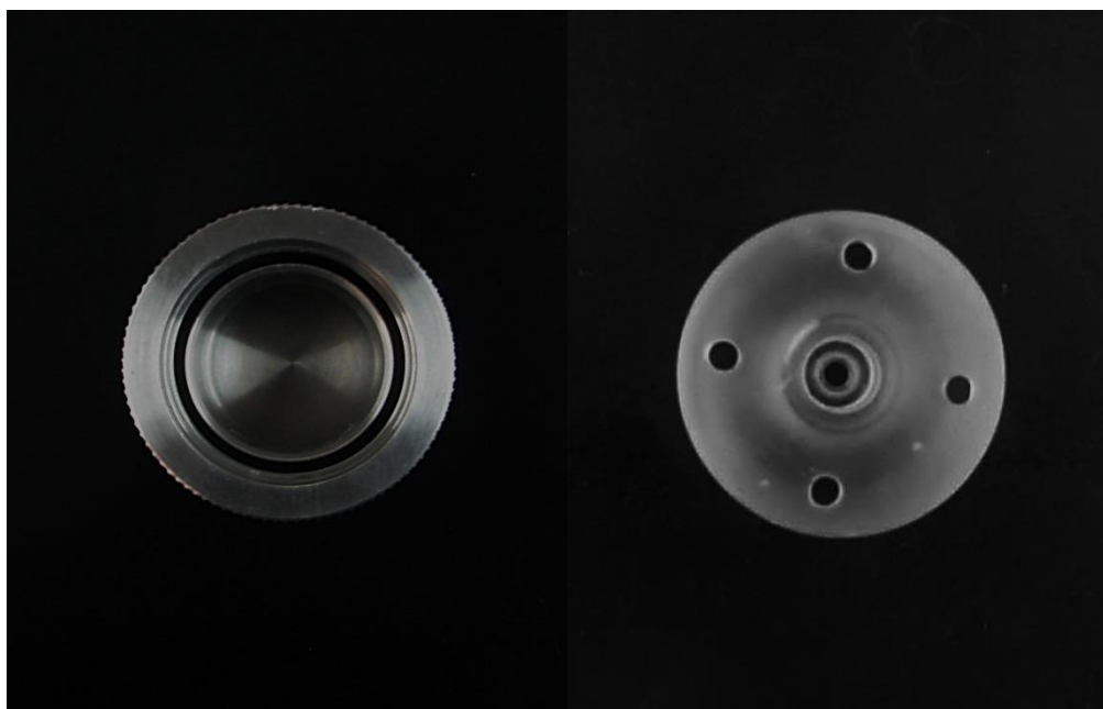
Figura 5.2. Geometría de dobles cilindros concéntricos (o Copa Couette).
