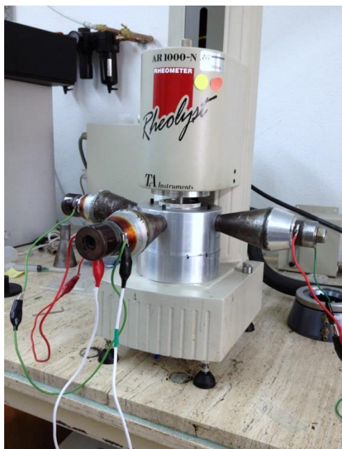
Figura 5.10. Fotografía del dispositivo para la aplicación de Ultrasonido, una vez montado y funcionando.
