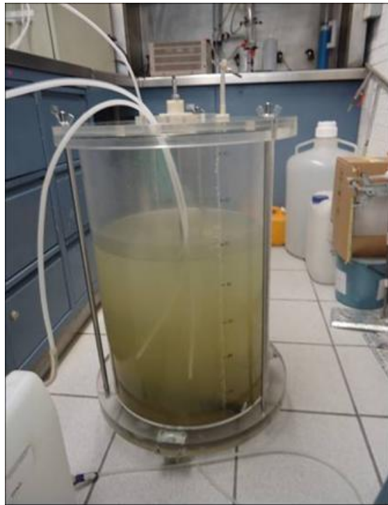
Figura 3.8. Reactor piloto de 70 litros en operación (sedimentación del O 3 DTPA)
