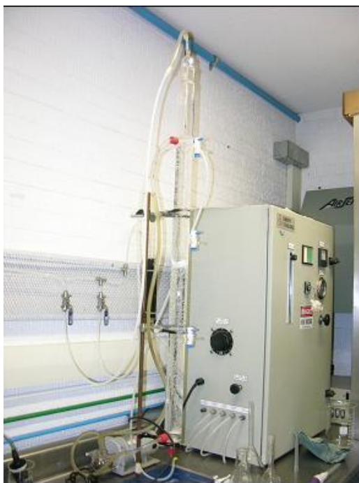
Figura 3.5. Reactor de columna de burbujeo empleado en la desinfección con ozono
