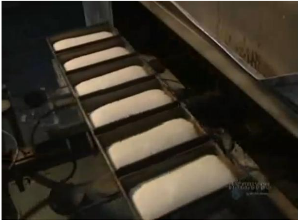
Figura 1.8.1 Piezas de masa en moldes a la entrada del horno
