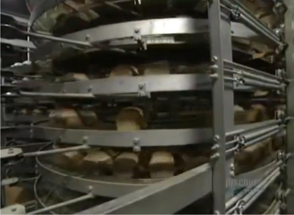
Figura 1.9.1 Piezas de pan girando en torre de enfriamiento
