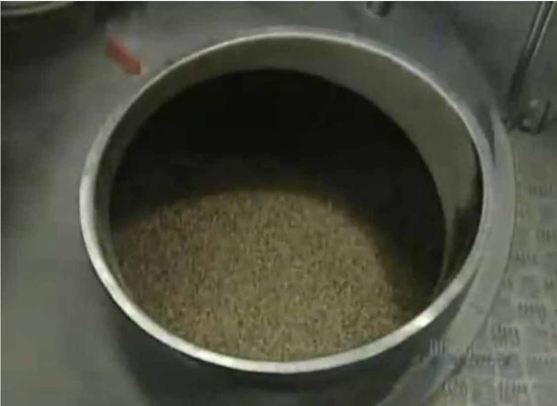
Figura 1.2.1 Tanque donde se observa la mezcla de ingredientes para obtener la esponja.
