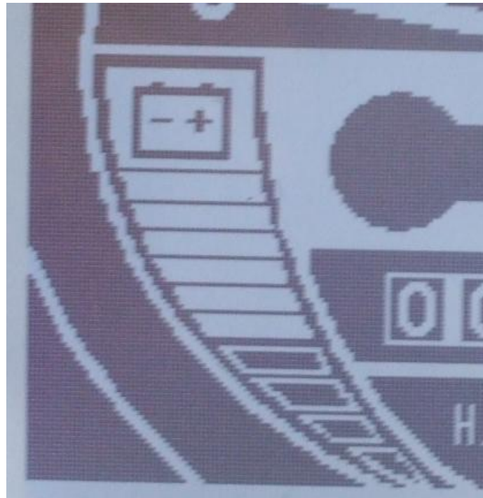
Figura 5.23. Display que muestra el estado de carga del banco de baterías.
