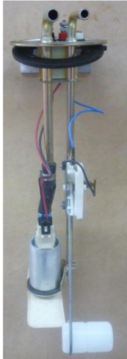
Figura 5.11. Flotador y bomba de gasolina.
