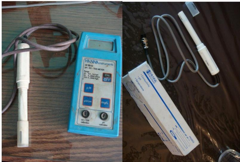
Figura 56: pHmetro de Hanna Instruments y su electrodo
