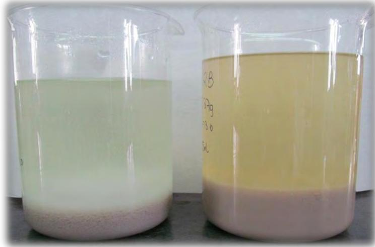
Fig.25 Proceso de precipitación por el método isoelectrico del lado izquierdo la extracción a pH =12 y del lado derecho la extracción a pH =13.6
