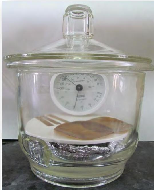
Fig. 14 Proceso de acondicionamiento de películas
