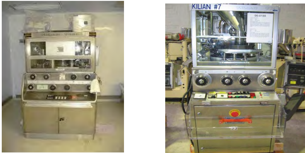
Fig.13. Ejemplos equipos de compresión.
