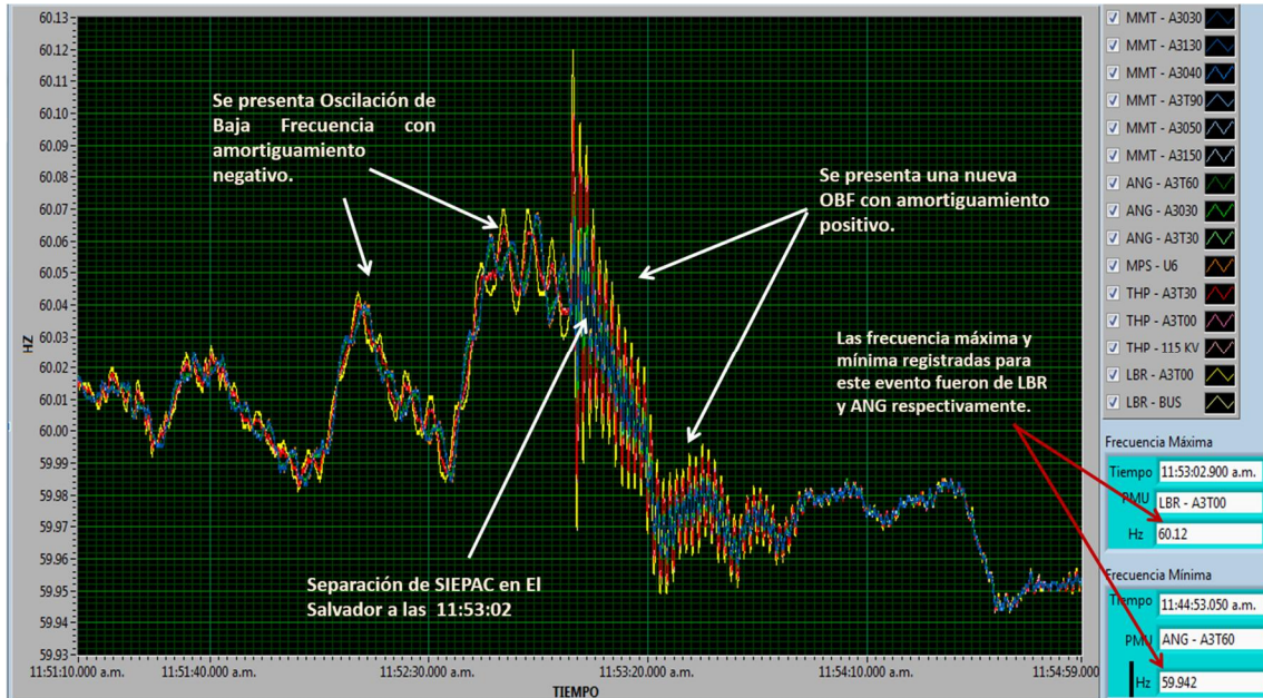
Figura 5.3 Comportamiento de la frecuencia del SIN y SIEPAC para el evento analizado
