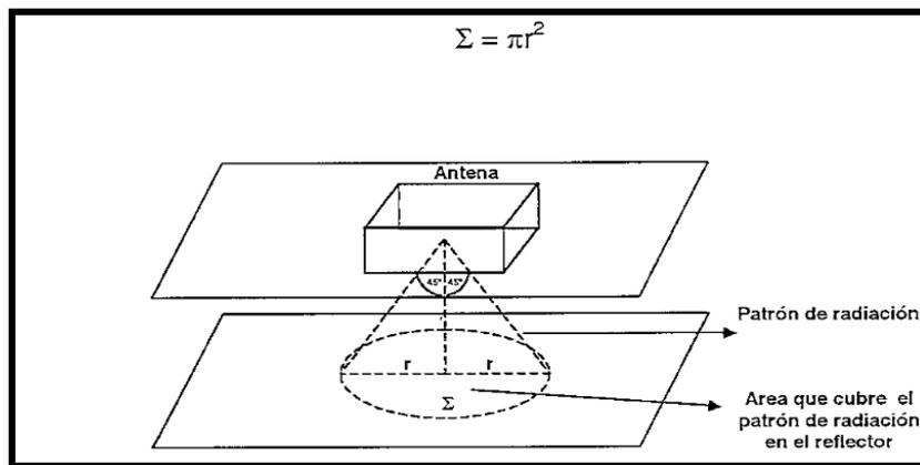
Figura (3.9) Área que cubre el cono de emisión de la antena sobre el reflector (Blancas, 2000).
