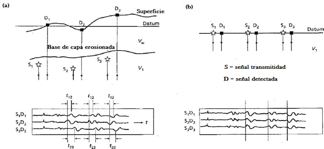
Figura (4.16) Corrección estática. (a) Radargrama que muestra la diferencia de tiempos entre los eventos de reflexión debido a la diferencia de elevación y la presencia de capa erosionada. (b) El mismo radargrama después de aplicar la corrección por elevación y la corrección por la capa erosionada, muestra un buen alineamiento de los eventos de reflexión (Después de O'Brien, 1974 En: Philip, 2002).
