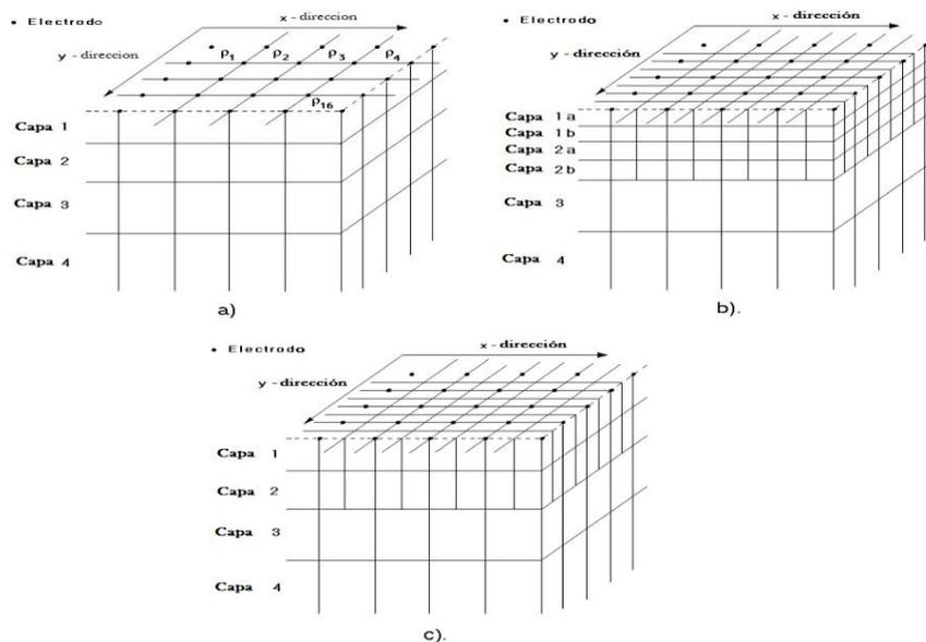
Figura (3.5) Los modelos usados en inversión (Loke, 1996)
