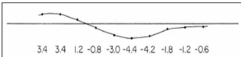
Figura (4.14) La señal de salida de un filtro FIR con los valores de amplitud promedio (Robinson, 1988)
