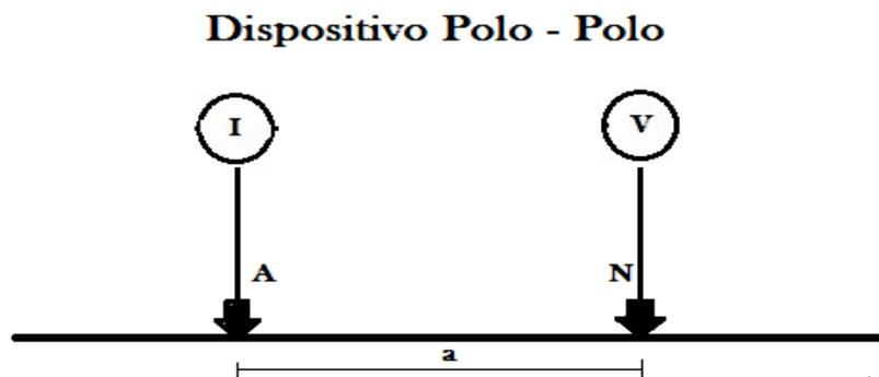
Considerando que las distancias entre electrodos  $r_{AN}$ ,  $r_{BM}$  y  $r_{BN}$  para este dispositivo son infinitamente grandes se tiene que el factor geométrico es  $k = 2\pi a$  y la resistividad calculada esta expresada como
