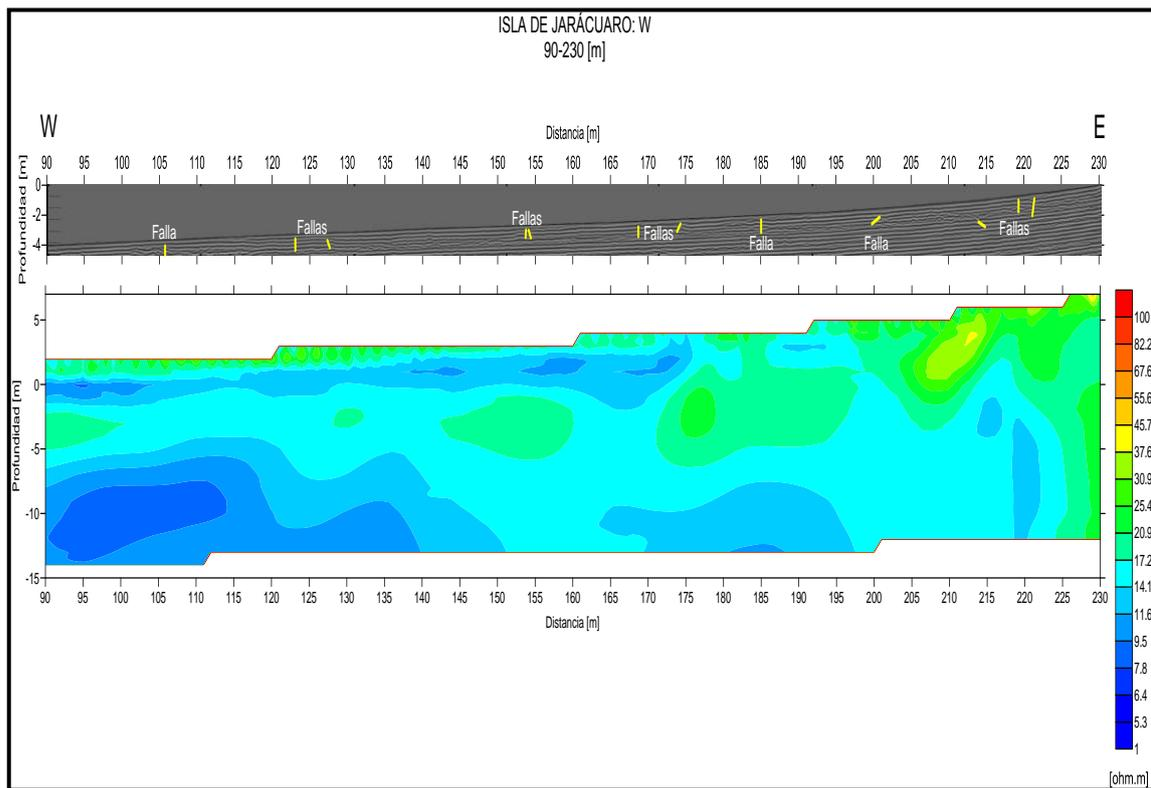
*Figura (5.2) Sección de radar y tomografía eléctrica procesada e interpretada*
