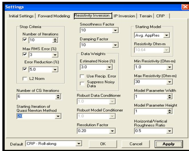
Figura (4.8) Ventana Resistivity Inversion, y los parámetros de inversión presentes (EarthImager 2D)
