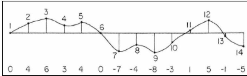
Figura (4.13) Ejemplo de una señal con sus respectivos valores de amplitud (Robinson, 1988)
