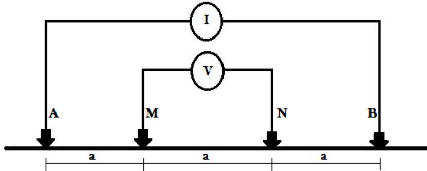
El factor geométrico para este dispositivo,  $k = 2\pi a$  aquí  $r_{AM} = a$  su fórmula para el cálculo de resistividad es:
