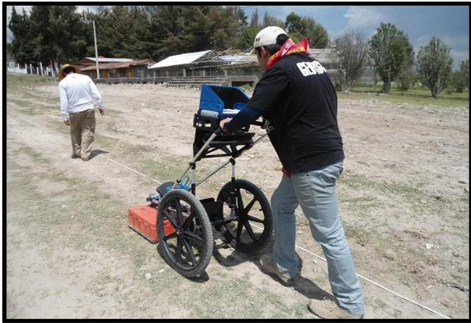
*Fig.(4.5) Se muestra la adquisición de datos con el equipo de radar*
