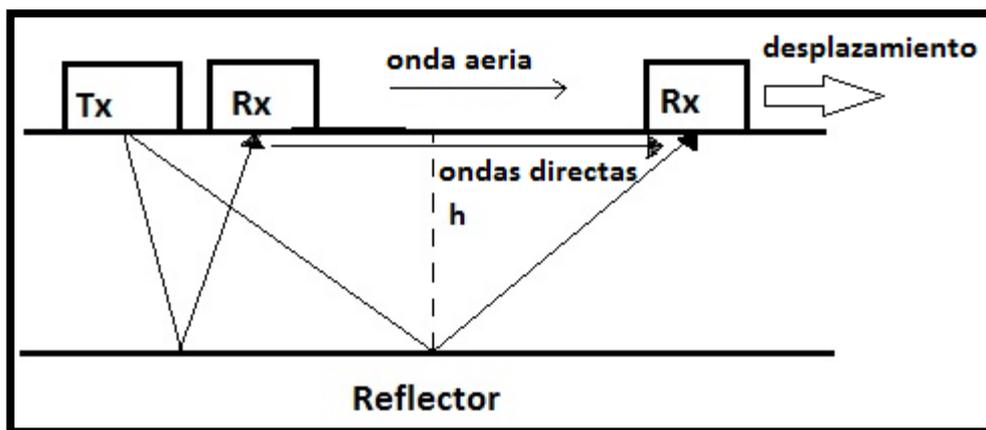
Figura (3.12) Diagrama de sondeo WARR para estimar los tiempos de reflexión en donde el transmisor (Tx) es fijado y el receptor (Rx) es desplazado en la dirección x en intervalos, (h) es la profundidad.
