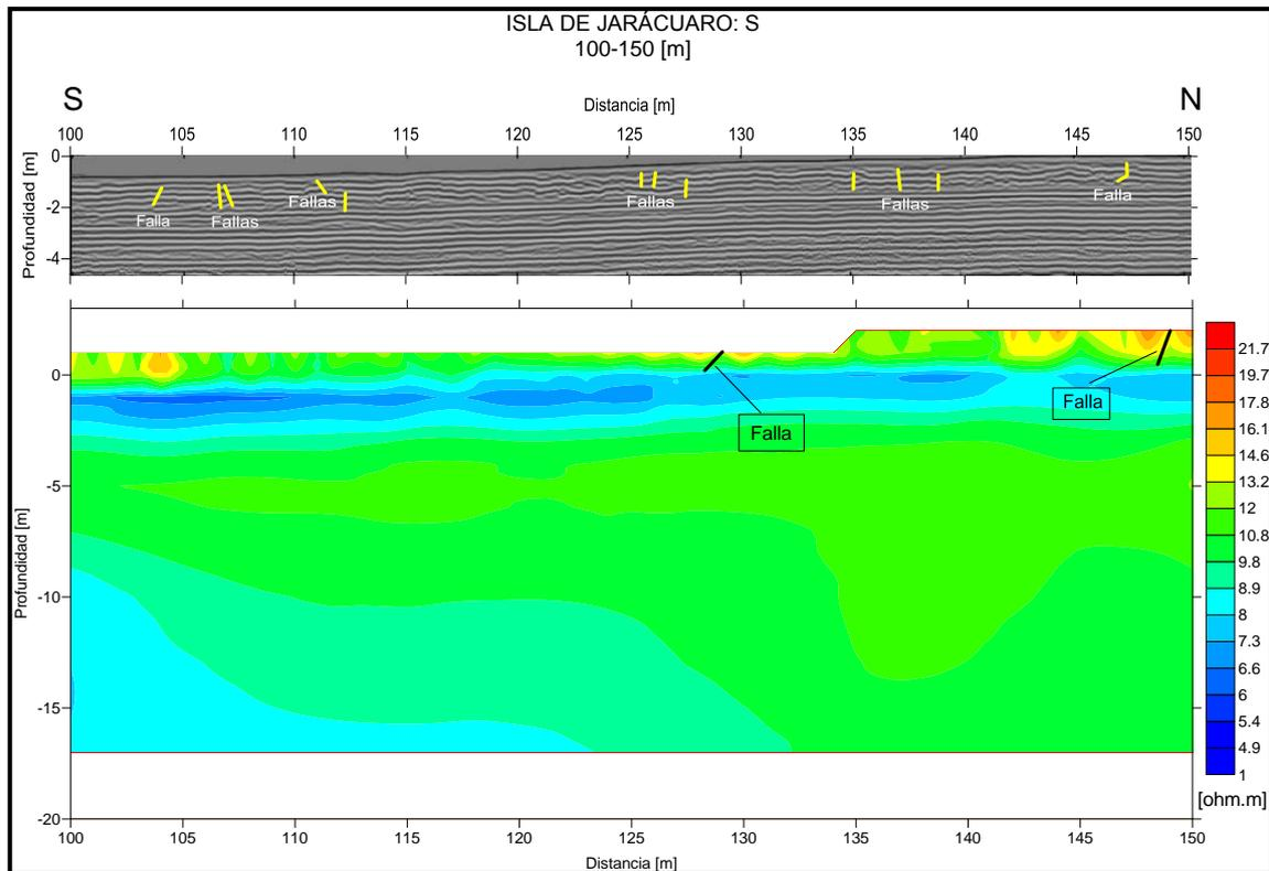
Figura (5.8) Sección de radar y tomografía eléctrica procesada e interpretada
