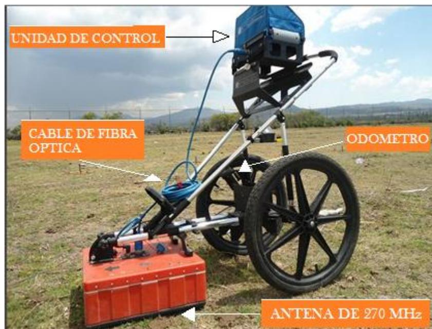
Figura (3.15) GPR con unidad de control SIR3000
