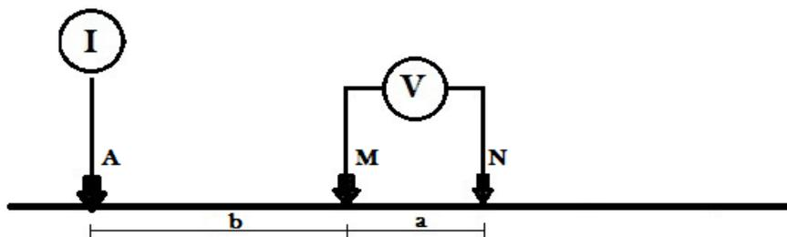
En este caso el electrodo se ubica en  $B \rightarrow \infty$ , considerando bajo esta condición que las magnitudes de las distancias  $r_{BM}$  y  $r_{BN}$  son mayor que  $r_{AM}$  y  $r_{AN}$ , entonces las relaciones que involucran con el factor geométrico  $1/r_{BM}$  y  $1/r_{BN}$  se desprecian y por lo tanto el factor geométrico será  $K = 2\pi na(n + 1)$ . La ecuación de resistividad para este dispositivo puede ser expresada de la siguiente manera
