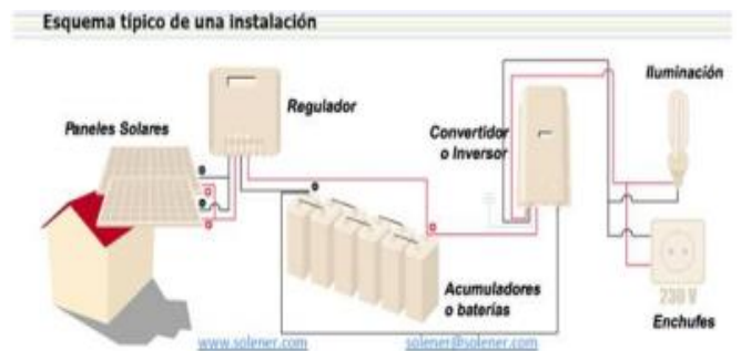
Esquema de funcionamiento del panel fotovoltaico..
