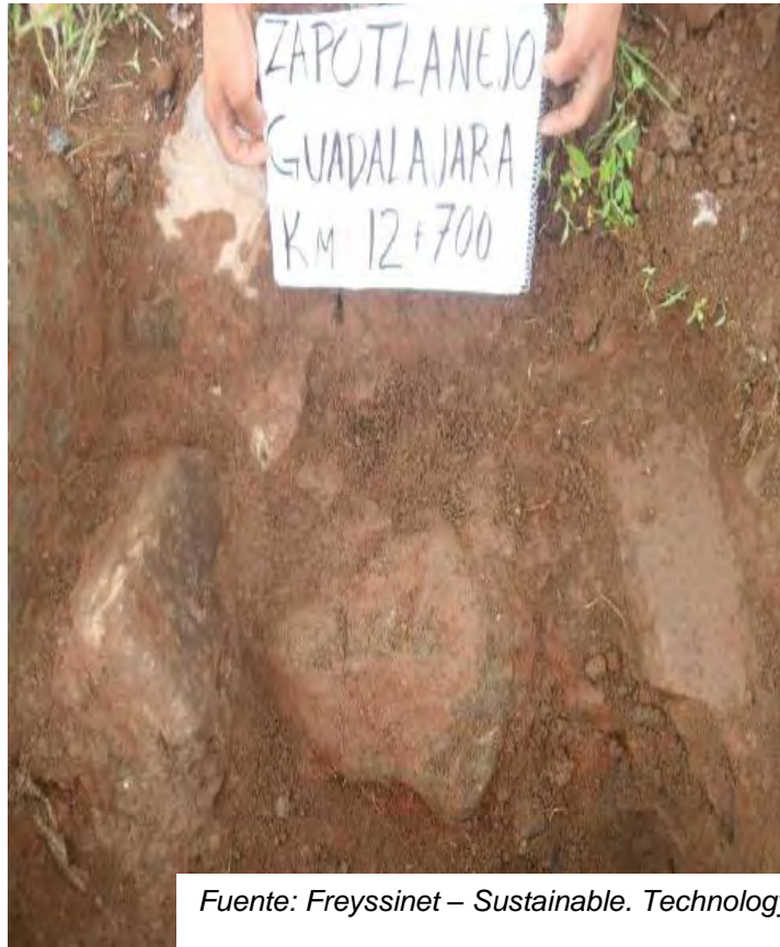
Figura 4.7. Pozo a cielo abierto.
