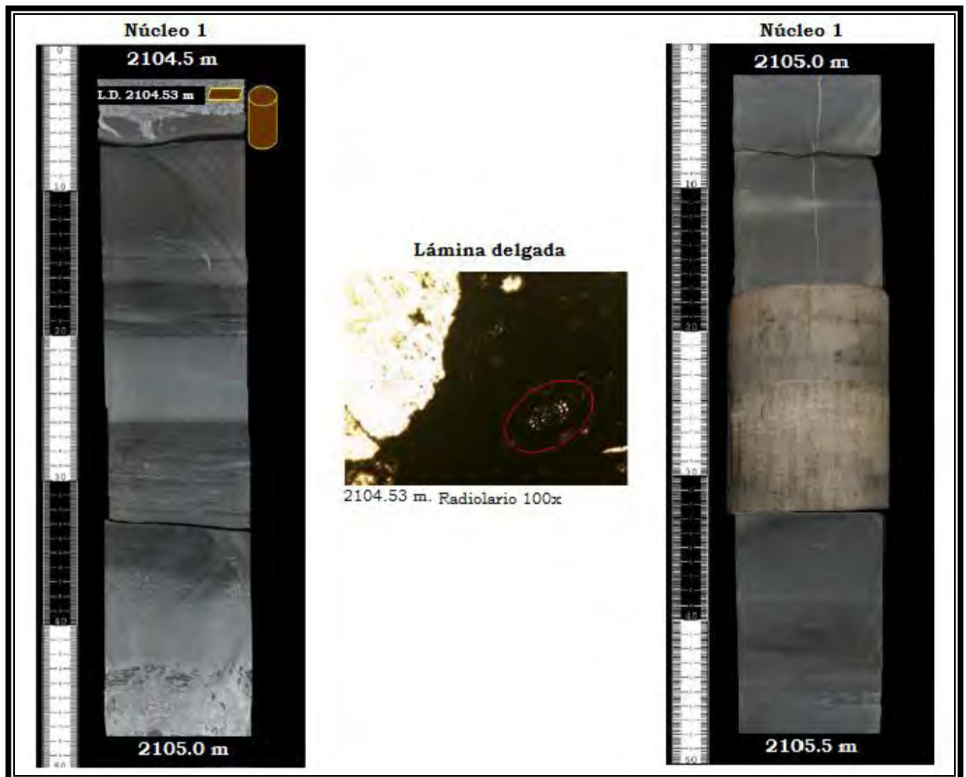
Figura 5.7 Núcleo 1 y lámina delgada del intervalo 2104.5-2105.5 m. (PEMEX 2 , 2013).
