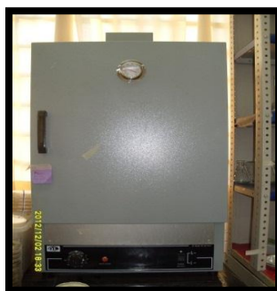
Figura 21. Estufa de aire caliente. Fuente: Elaboración propia.
