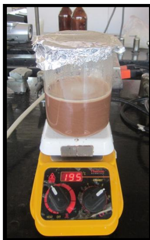
Figura 26. Extracción de materia extraña (Lavado con solución detergente). Fuente: Elaboración propia.
