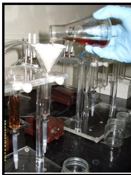
Figura 28 . Extracción de Aflatoxinas: Filtrado del extracto. Fuente: Elaboración propia.
